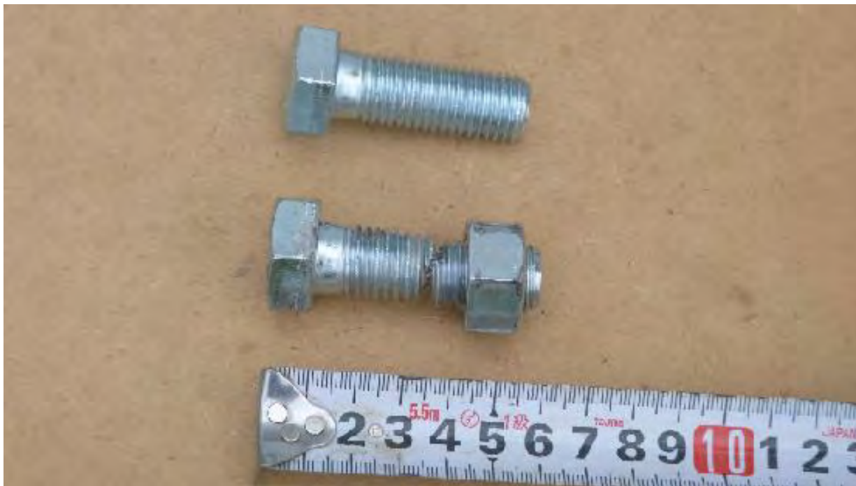
（上：新品のボルト、下：破損したボルト）
