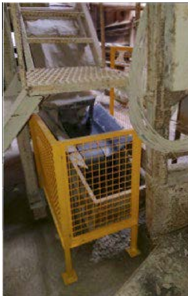
対策3:ベルトコンベア反対側へ囲い設置
