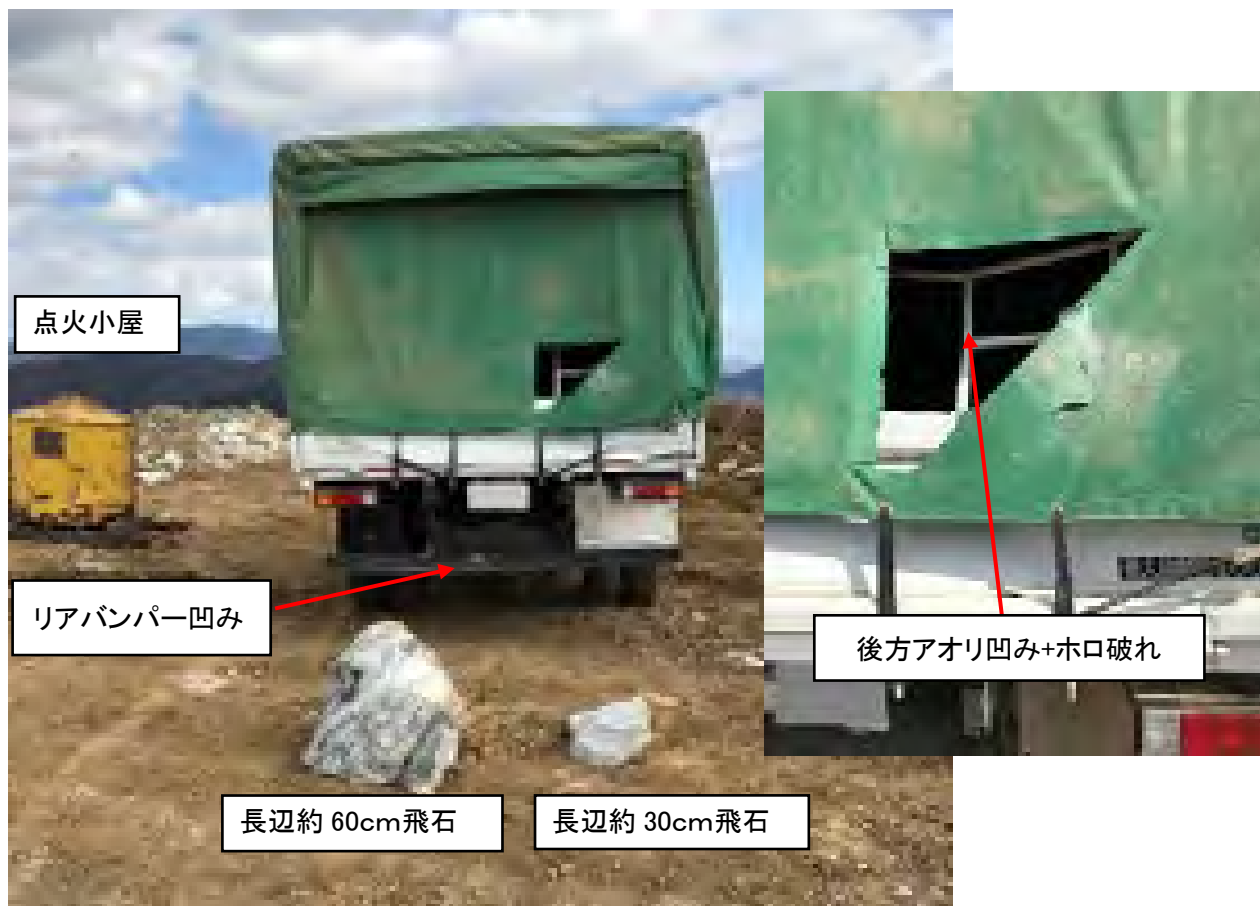
写真4 飛石による火薬運搬車破損状況
