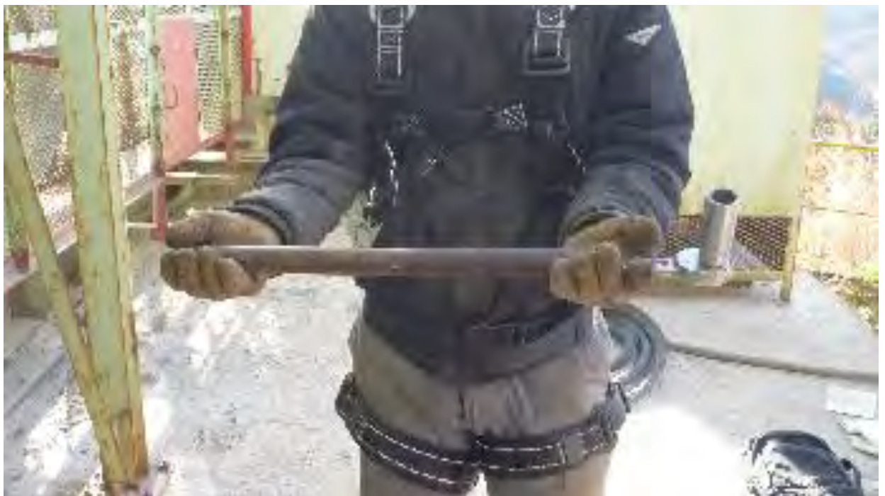
写真6：罹災者がボルトの締め付けに使用したラチェットレンチ
