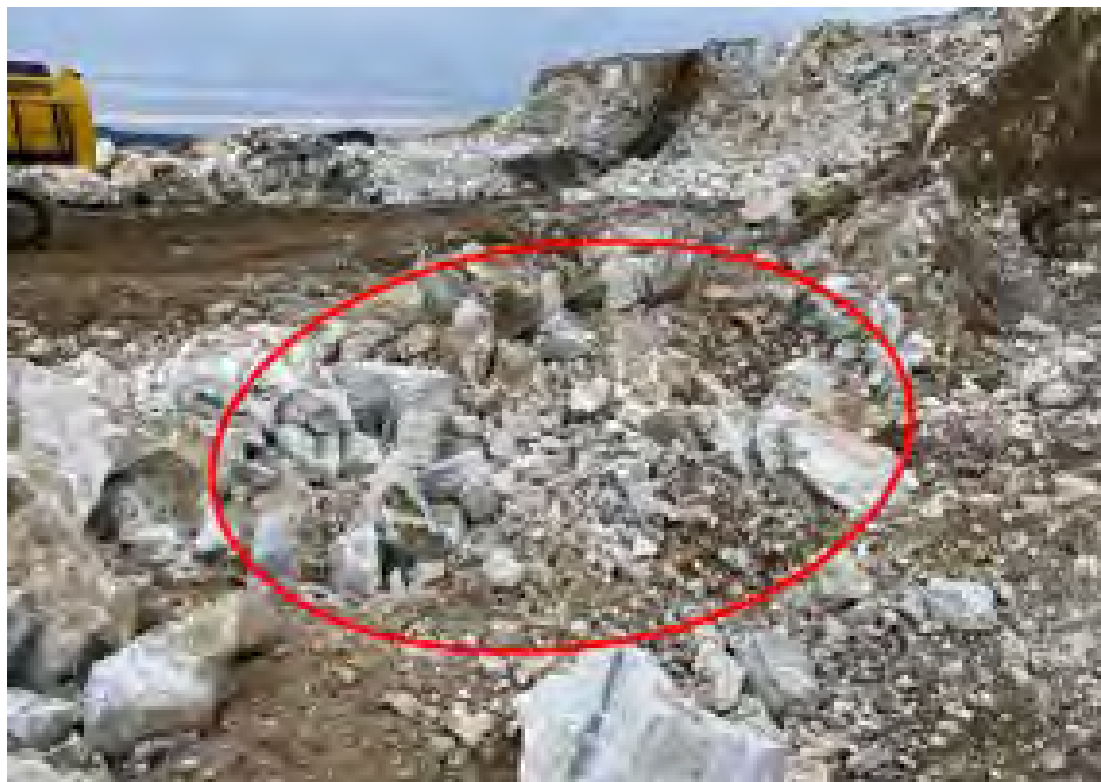
写真 3 飛石の岩質から推定される飛石発生位置
