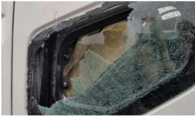
写真 2-2：左側ドア足元ガラス破損
