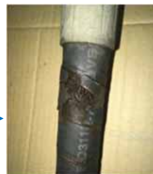
30年9月 火災重機の油圧ホース(右は拡大)
