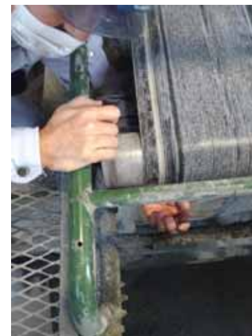
31年1月の巻き込まれ状況（再現） 【ベルト幅50cm】
