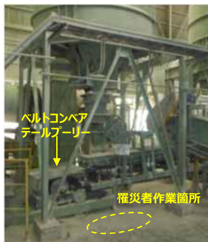
30年8月の巻き込まれ発生箇所 【ベルト幅60cm】
